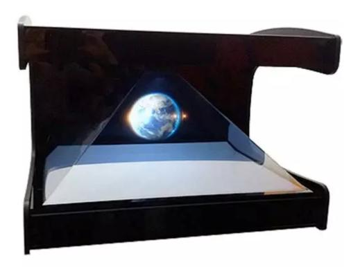
5. **Holographie par réflexion** : Dans cette méthode, l'image holographique est réfléchie par un miroir transparent ou semi-transparent, permettant aux spectateurs de voir l'image à partir de différents angles.
